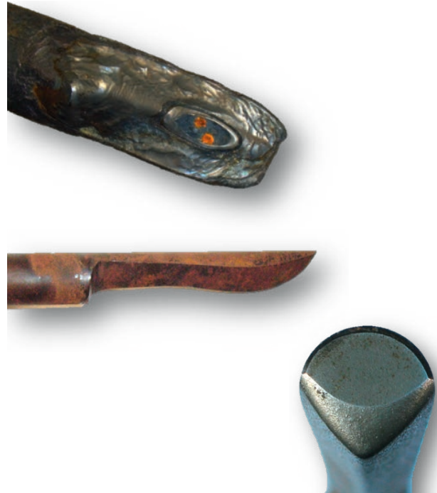
Beschädigungen abrasiv belasteter Schutzrohre (Beispiele)
