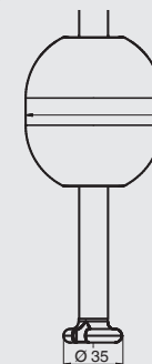
Исполнение с приварным торцом трубы
