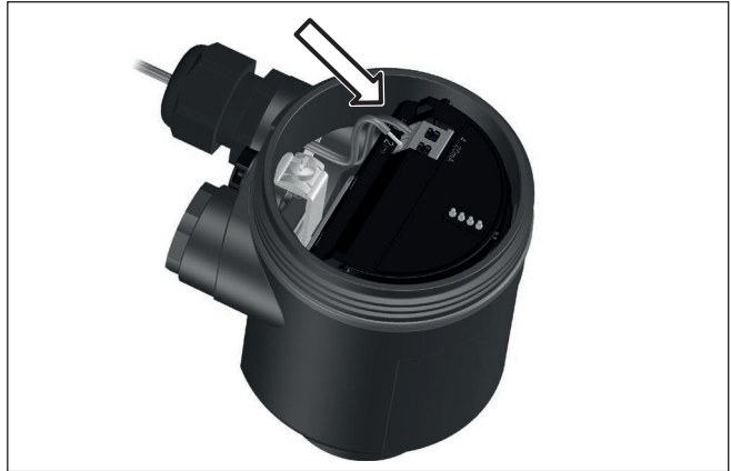
Abb. 26: Anschlusschritte 5 und 6 - Einkammergehäuse
