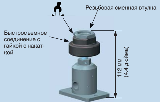
Поставка под измерительный прибор на 2500 бар (36250 ф/кв. дюйм)
