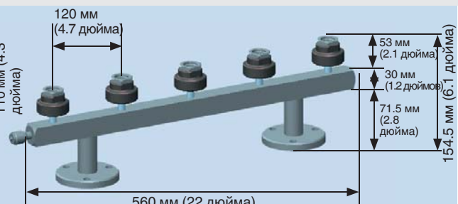
Пятиходовой коллектор на 1600 бар (23200 ф/кв. дюйм), отдельно стоящий
