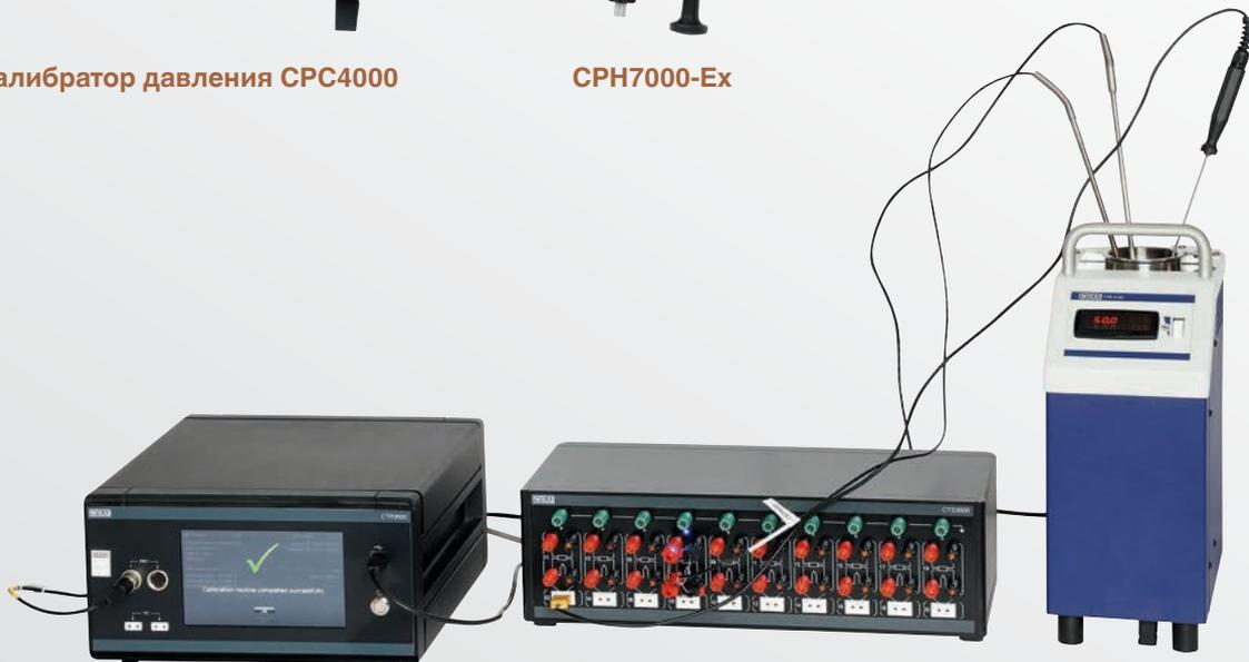
**Высокоточный термометр CTR3000 с мультиплексором CTS3000**
