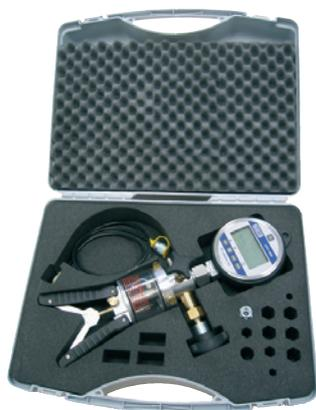
**Valigetta di calibrazione con manometro digitale di precisione modello CPG1000 e pompa di test idraulica manuale modello CPP700-H, per pressioni da 0 ... 700 bar, composta da:**
