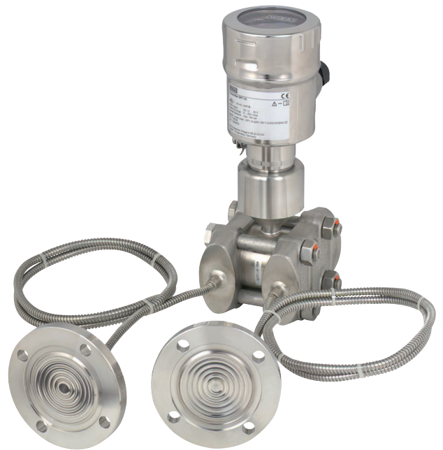
Trasmettitore di pressione differenziale connesso a due separatori a membrana di tipo flangiato tramite un capillare
