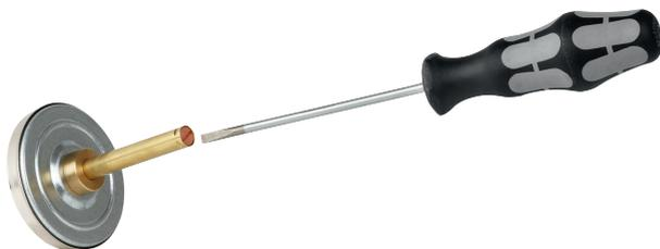
Винт в торце штока (см. рисунок) служит для коррекции показаний. Поворот винта приводит к одновременному изменению отображаемого значения и должен производиться только после консультации с производителем. После консультации выполните шаги 1 ... 4.
