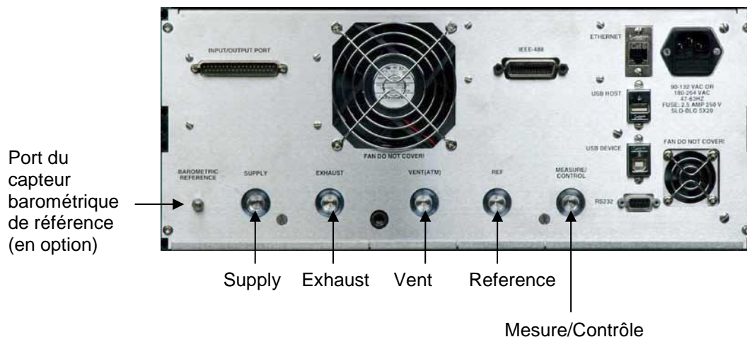
Figure 4-4 Connexion pneumatique du panneau arrière
