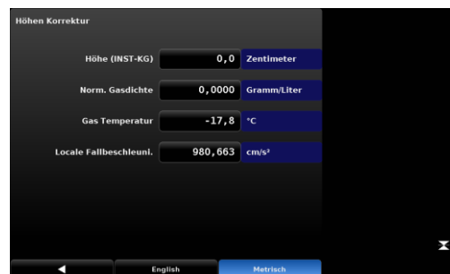
Figure 7-1 - Ecran correction de hauteur unités métriques
